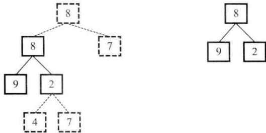
图 3.15 在树 A 中找到第二个值为 8 的节点，该节点下面（实线部分）的结构和树 B 的结构一致
